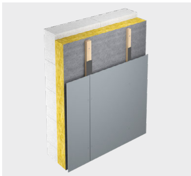
Traglattung durch Rahmendübel im Untergrund befestigt
