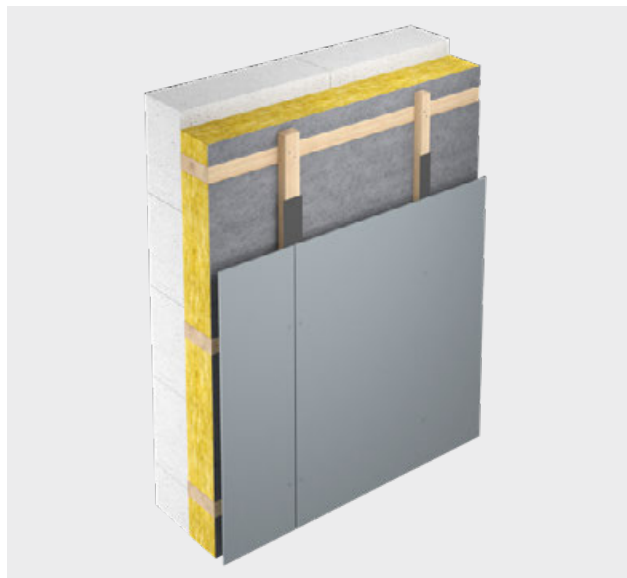
Konstruktion mit horizontaler Konterlattung
