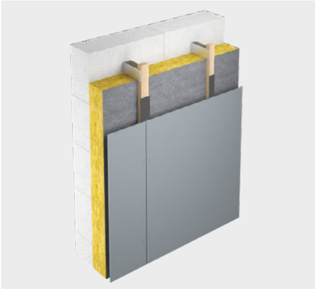
Holzunterkonstruktion mit Abstandhaltern
